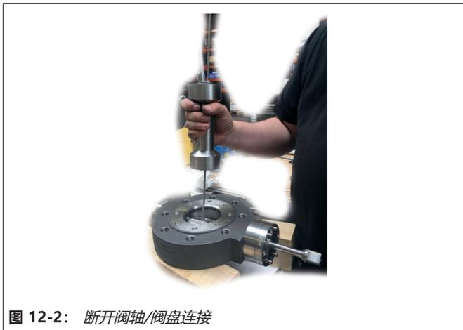
图 12-2: 断开阀轴/阀盘连接
