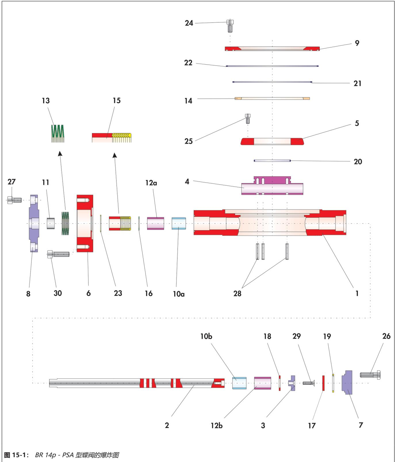
图 15-1: BR 14p - PSA 型蝶阀的爆炸图
