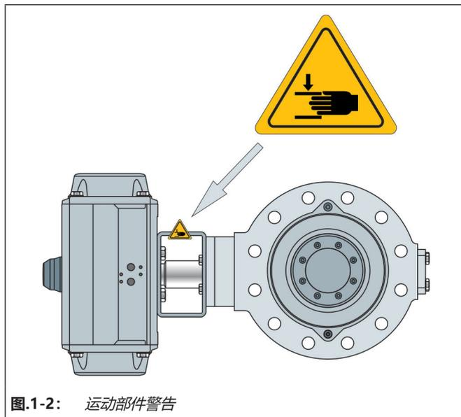
只要已将气源连接至执行机构, 当执行机构和控制轴进入托架时, 其旋转运动就可能引起夹伤危险。经操作员请求, 阀门上可能贴附警告说明。
