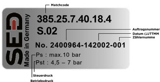
Typenschild für Ventile > DN25
