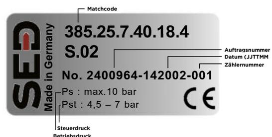
Das Typenschild wird in Form eines Klebeschildes auf dem Gerät angebracht und enthält wichtige Informationen zum Betrieb.
