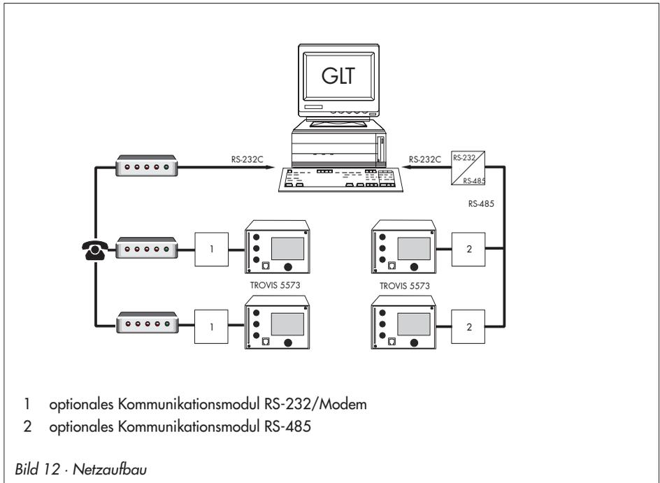
**Hinweis:** Die Betriebssoftware kann über Modem oder Datenkabel aktualisiert werden, sofern mit CO6 -> F01 - 1 der Modbus aktiviert ist.
