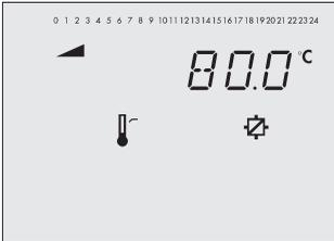
maximale Ladetemperatur (nur mit VF4)
