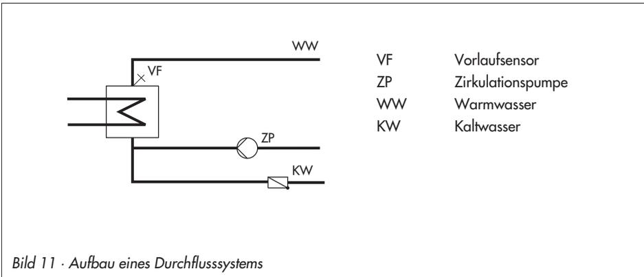
Die Regelung der gewünschten *Trinkwassertemperatur* am Sensor VF ist nur während der Nutzungszeiträume der Zirkulationspumpe ZP aktiv.
