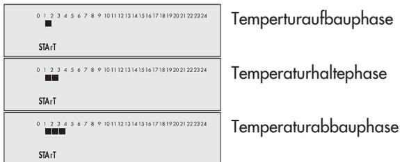
Erlischt die Zusatzanzeige im Bild der Vorlauftemperaturanzeige nach der letzten Phase, ist die Estrichtrocknung ordnungsgemäß abgelaufen.
