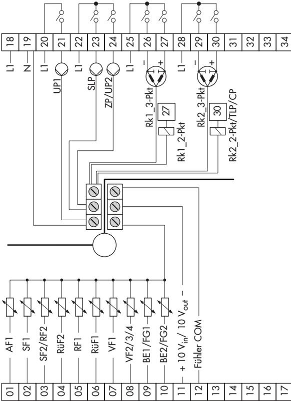
Bild 14 · Anschluss des Reglers TROVIS 5573 mit Standard-Gehäuserückteil
