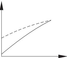
**Sinkt die Raumtemperatur in der Übergangsjahreszeit**, ist eine Erhöhung des Niveaus und gleichzeitige Verringerung der Steigung erforderlich.
