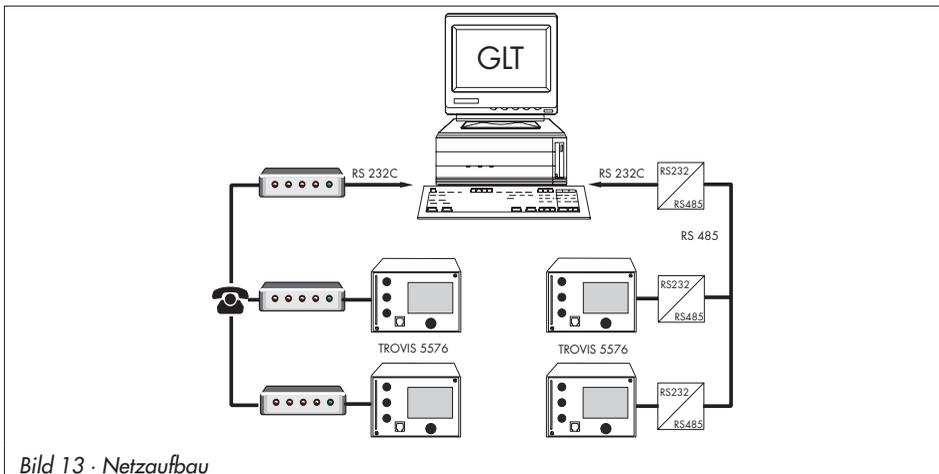
Bild 13 · Netzaufbau
