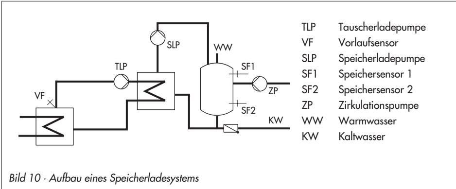
Der Regler startet die Speicherladung, wenn die am Sensor SF1 gemessene Wassertemperatur den *Sollwert Trinkwassertemperatur* um  $0,1\text{ }^{\circ}\text{C}$  unterschreitet. Ist die Vorlaufstemperatur in der Anlage höher als die gewünschte Ladetemperatur, versucht der Regler bis zu 3 Minuten lang, diese heizkreisseitig abzubauen, bevor die Tauscherladepumpe zusammen mit der Speicherladepumpe in Betrieb gesetzt wird.
