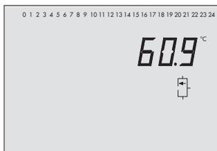
Temperatur am Speichersensoren SF1 (Trinkwasserspeicher)
