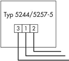
Bild 7 · Anschlussplan Raumleitgerät Typ 5244/5257-5 an TROVIS 5576 für Rk1 **oder** Rk2
