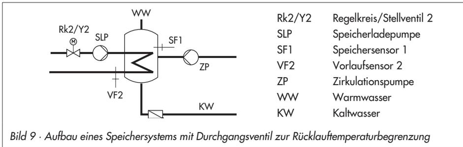
Durchgangsregelventil und Temperatursensor VF2 dienen in der oben dargestellten Schaltungsvariante ausschließlich der Rücklaufftemperaturbegrenzung. Der Vorregelkreis stellt wie in der Standardschaltung mindestens eine Vorlauftemperatur zur Verfügung, die sich aus *Sollwert Trinkwassertemperatur + Überhöhung Ladetemperatur + Überhöhung Sollwert Primärtauscherregelung* ergibt.
