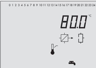
maximale Ladetemperatur (nur mit VF4)
