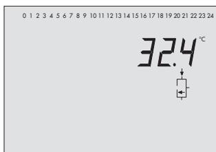
Temperatur am Speichersensoren SF3 (Trinkwasserspeicher)
