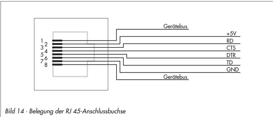
Bild 14 · Belegung der RJ 45-Anschlussbuchse
