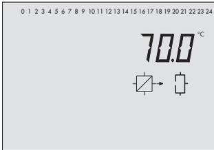
Temperatur am Vorlaufsensor VF2, Trinkwasserkreis
