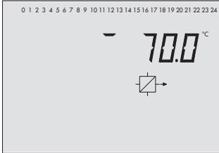
Temperatur am Vorlaufsensor VF1, Primärtauscherkreis
