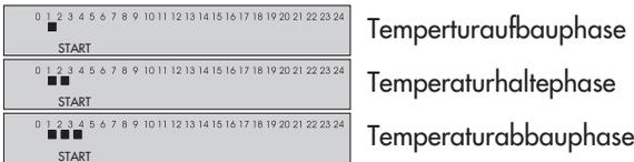
Erlischt die Zusatzanzeige im Bild der Vorlauftemperaturanzeige nach der letzten Phase, ist die Estrichrocknung ordnungsgemäß abgelaufen.
