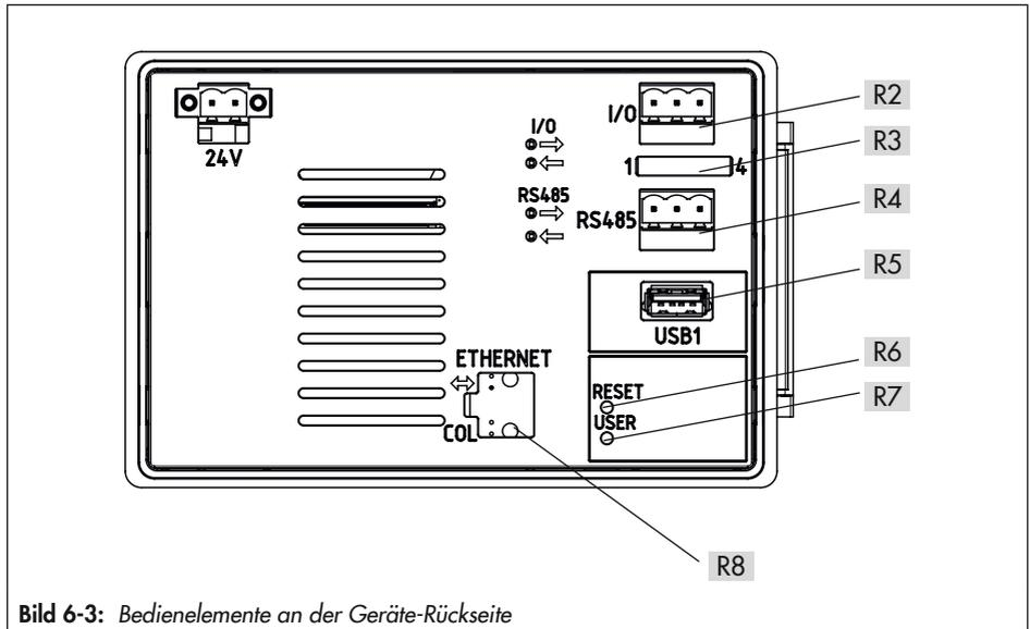
**Bild 6-3:** Bedienelemente an der Geräte-Rückseite
