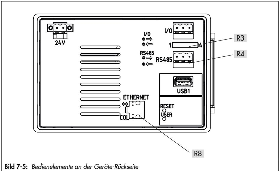
Bild 7-5: Bedienelemente an der Geräte-Rückseite
