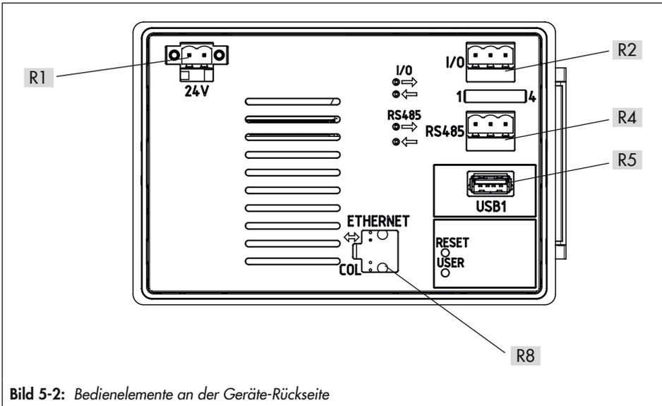
**Bild 5-2:** Bedienelemente an der Geräte-Rückseite
