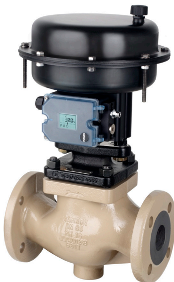
Tipo 3372 com 350 cm 2 de área do atuador e posicionador Tipo 3725
