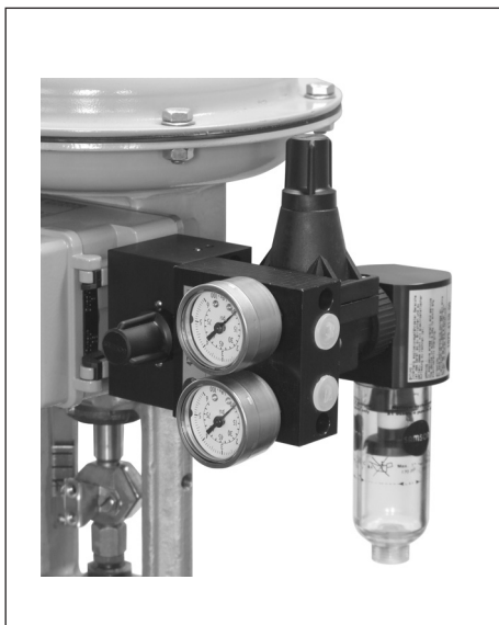
Рис. 14: Переключатель ручного/автоматического режимов Тип 4708-82, регулятор давления Тип 4708-53 с манометрами и корпусом фильтра
